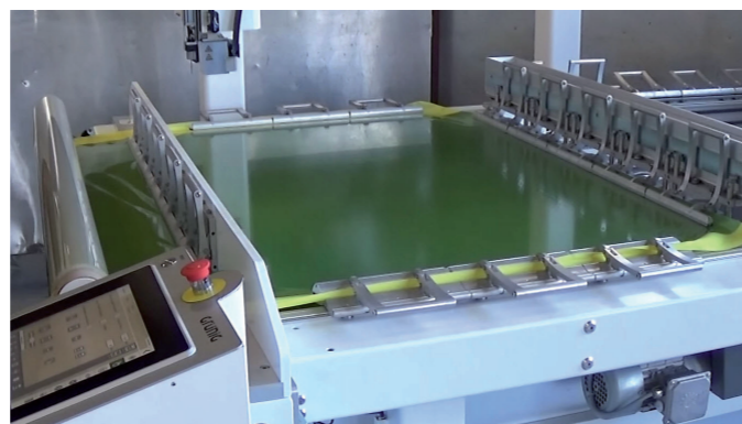
Traitement de tissus avec enduction préliminaire (PCF)
